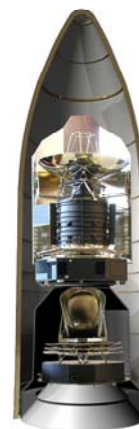
Représentation artistique de Herschel (en haut) et de Planck (en bas) à l'intérieur de la coiffe de charge utile d'Ariane 5.
