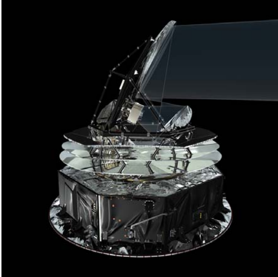
Représentation générée par ordinateur du satellite Planck qui montre le cheminement d'un rayonnement lumineux à travers le télescope (Crédit : ESA)
