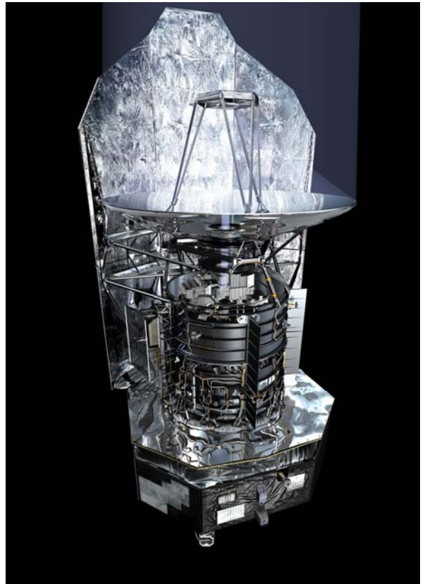
Représentation en coupe, générée par ordinateur, du satellite Herschel, avec vue sur le cryostat et les instruments scientifiques. On distingue le bouclier solaire à l'arrière-plan. (Crédit: ESA)
